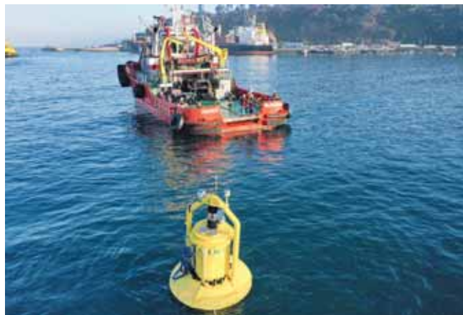
El PB3 PowerBuoy está instalado frente a las costas de Las Cruces en la Región de Valparaíso, es el primer convertidor de energía de las olas a escala industrial en Latinoamérica y el quinto a nivel mundial.
