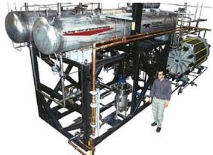
Instalación comercial de producción de H 2 (150 m 3 /h) mediante electrolisis de agua
