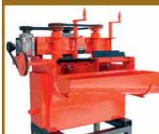
CELDA DE FLOTACIÓN
