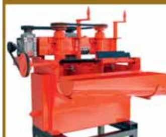
CELDA DE FLOTACIÓN
